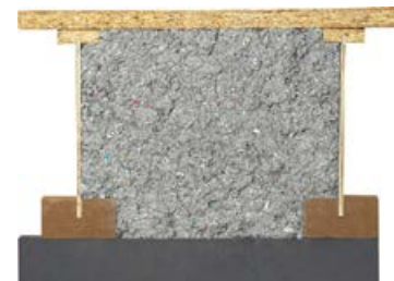
Sparrenexpander in Dämmplattenstreifen eingesteckt!
